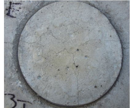
Slika 3. Izgled uzorka nakon jednosatnog zagrijavanja propanskim plamenom
