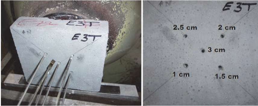
Slika 1. Uzorci s termočlancima: a) vanjska strana; b) položaj termočlanaka
