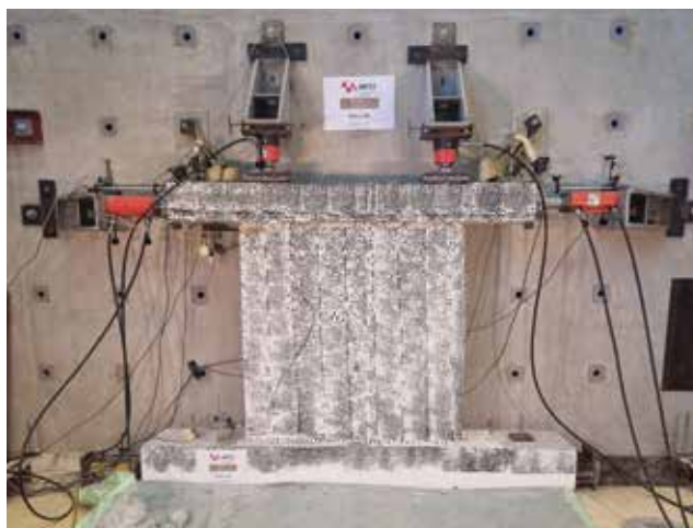
Zid od nabijene zemlje nakon provedenog ispitivanja
