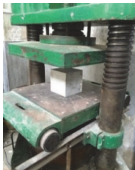
Slika 2. Preša za nanošenje opterećenja
