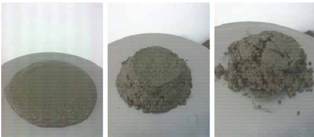
Slika 7. Obradivost morta bez vlakana, 0,5 % vlakna, 1 % vlakana
