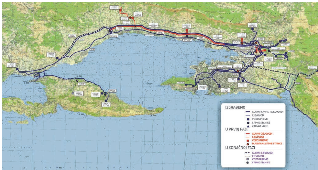
Prikaz vodoopskrbnog sustava Splita, Solina, Kaštela i Trogira (I. faza)
