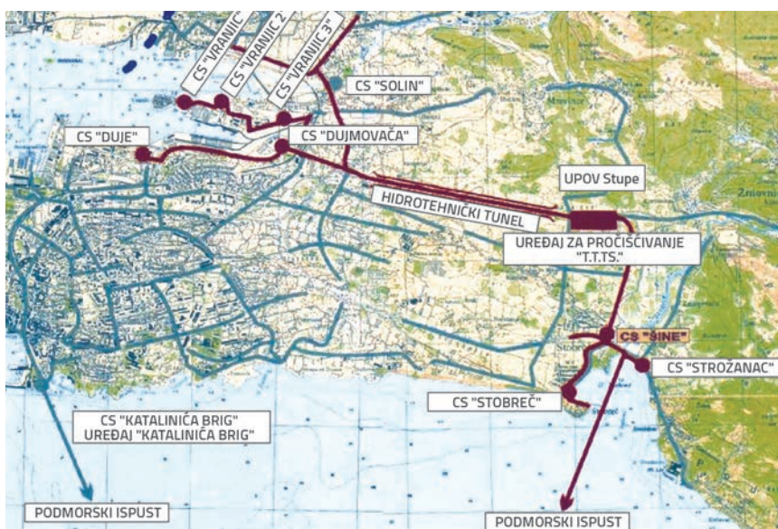
Prikaz kanalizacijskog sustava Solin – Split
