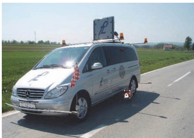
Slika 2. Dinamičko mjerenje noćne vidljivosti oznaka na kolniku
