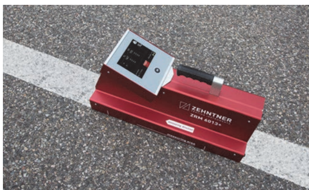
Slika 1. Mjerenje vidljivosti (dnevna i noćna) oznaka na kolniku pomoću statičkog retroreflektometra [21]
