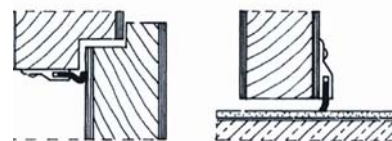
Slika 3. Posebni profili za brtvljenje razmaka između vratnih krila i poda
